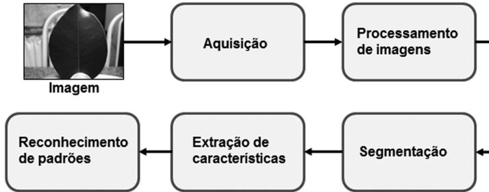
Figura 1.2: Esquema de um sistema de visão computacional.
