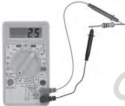
De acordo com a Figura 1.23, as pontas de prova precisam estar conectadas aos dois terminais do resistor.
