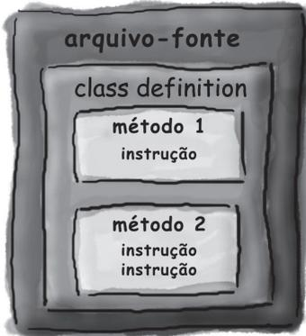
Um arquivo de código-fonte (com a extensão *.java*) contém uma definição de **classe**. A classe representa uma *parte* do seu programa, mesmo que uma aplicação pequena precise de uma única classe. A classe deve ficar dentro de um par de chaves.
